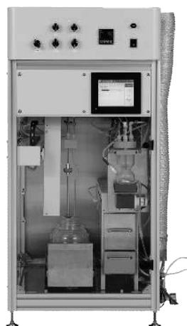
JIS K 0102.24.3抽出容器による抽出法に基づき、n-ヘキサン抽出を自動化した装置です。
